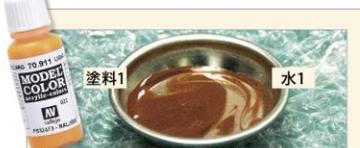
モデルカラーとゲームカラーをエアブラシで吹く時は、塗料:水(1:1)の割合で薄めて下さい。塗料皿の中で静かに混ぜ、カップに注ぎます。
