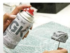
ファレホは定着性が高い塗料とは言え、本キットの材質であるレジンは、プラスチックほど塗料の「食いつき」が良くありません。塗装前にきちんとサーフェイス(サフ)で「下地処理」をしましょう。今回は成型色の上から新たに塗装するので、パーツ全てに「造形村GKサーフェイス」を吹きまわります。強力な成分により、はがれにくい強固な下地が形成されます。臭いが強いので使用時にはご注意ください。
